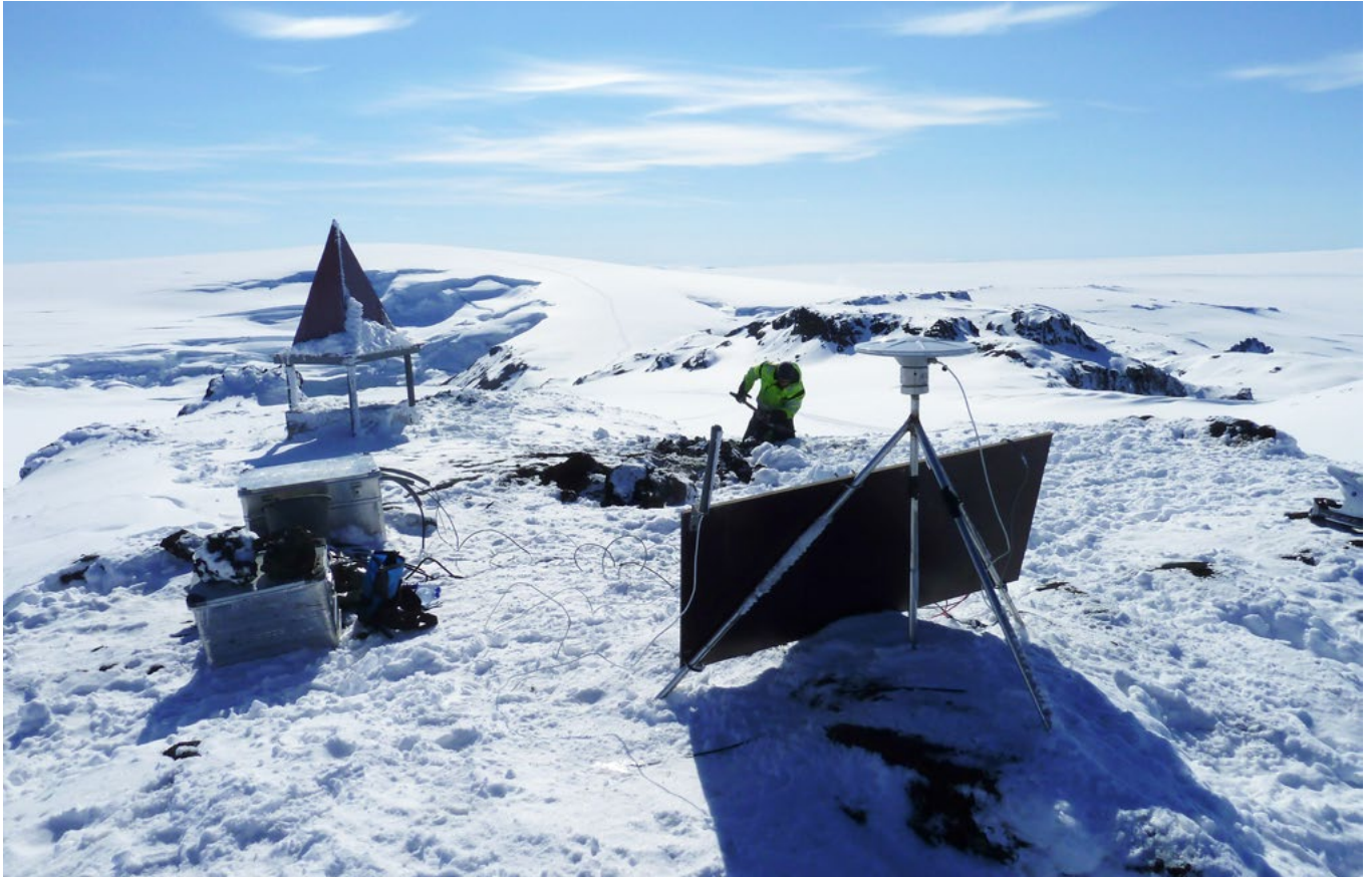
Uppsetning skjálfta- og GPS-stöðvar í Kverkfjöllum 21. ágúst. Bergur H. Bergsson mokar fyrir skjálftanema. Í forgrunni er GPS loftnet og kistur með tækjum og rafgeymum. Þríhyrningslaga pallurinn er VHF endurvarpi. Myndin er tekin til suðurs með Gengissig í baksýn. Ljósmynd: Benedikt G. Ófeigsson.
