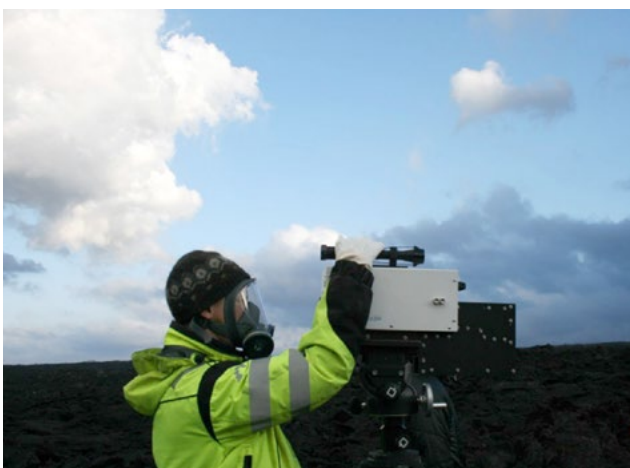
Baldur Bergsson við mælingar á gasstyrk í gasmekkinum við Holuhraun (FTIR). Ljósmynd: Gerður Stefánsdóttir.
