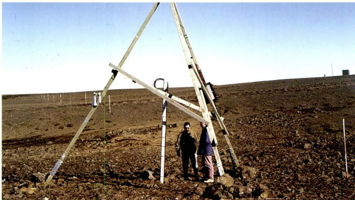
Útbúnaður til sjálfvirkra mælinga á snjódypt á Hveravöllum. Þetta er tilraunaverkefni, en stefnt er að því að beita samskonar mæliaðferðum við snjódyptarmælingar á snjóflóðahættusvæðum í framtíðinni (ljósm.: Flosi Hrafn Sigurðsson).
