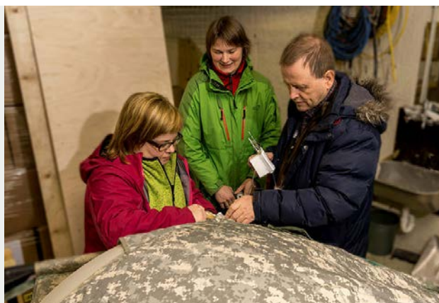
Veðurfræðingarnir Guðrún Nína Petersen, Sibylle von Lövis og Halldór Björnsson gera klárt til að senda loftbelg upp í háloftin sem mælir vind, hita, raka, loftþrýsting og ryk í tuttugu kílómetra hæð. Ljósmynd: Sigurjón Magnússon.
