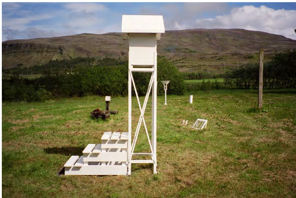
Mynd 3. Korpa 27. júní 2006 mönnuð veðurstöð. Mælaskýlið í forgrunni en fyrir aftan jarðvegshitamælur á grind, hitamælir við jörð og svo úrkomumælir. Úlfarsfell í bakgrunni. Ljósmynd: Elvar Ástráðsson
