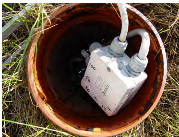
Mynd 5. Þykkvibær 7. október 2004. Nærmynd af hluta jarðvegshitamælitaekja. Á kassann er ritað 10, 30, 50 og 100, sem ætla má að séu dýpi mæla í cm. Ljósmynd: Sigvaldi Árnason
