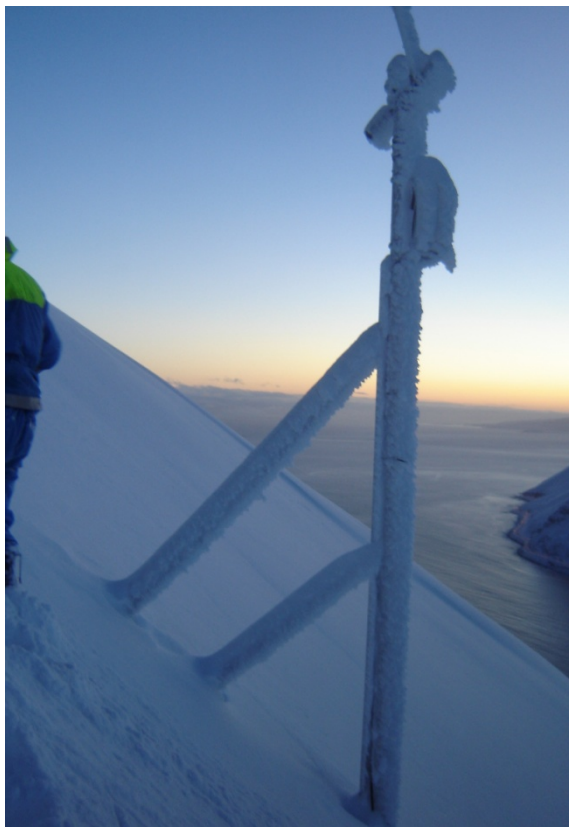
Mynd 4. Ísingarkápa á snjódýptarmælum og mastri í Traðargili 9. desember 2006. SM4 er á efri stoðinni. Ljósmynd: Veðurstofa Íslands.
