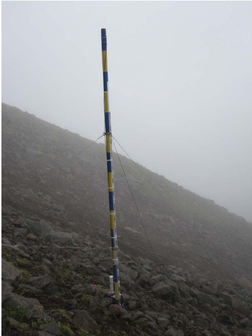
Mynd 1. Snjódýptarmælir í upptakasvæði að sumarlagi. Ljósmynd: Örn Ingólfsson.
