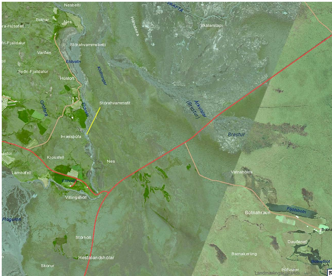
Mynd 10. Gardurinn sem lokar fyrir Ásakvíslar er merktur með gulu vinstra megin á myndinni. Gardar sjást vestan við Árkvíslar (Brest) (ekki merktir sérstaklega). Vatnið sem þessar gardar veita nú til austurs hefði sameinast í Ásakvíslum. Uppgræðsla með lúpínu er í fyrirverandi farvegum Ásakvísla sem dökkgræn svæði á myndinni. Gögn frá Landmælingum Íslands.
