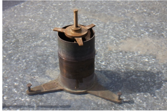
Mynd 1. Uppgufunarpannan í mælireit Veðurstofunnar. Í miðju pönnunnar er hólkur sem dempar gárur og öldugang og míkrómælir til mælinga á hæð vatnsborðsins. Ljósmyndir: Þórður Arason 22. júlí 2015.
