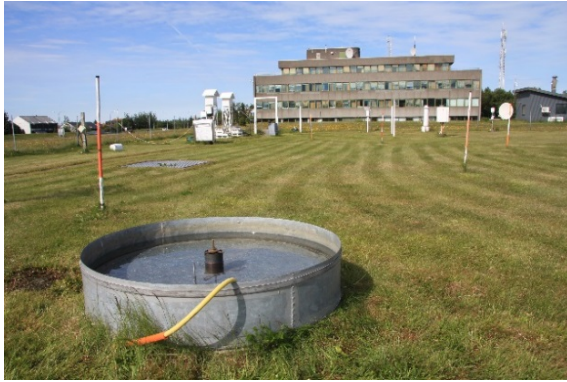
Mynd 1. Uppgufunarpannan í mælireit Veðurstofunnar. Í miðju pönnunnar er hólkur sem dempar gárur og öldugang og míkrómælir til mælinga á hæð vatnsborðsins. Ljósmyndir: Þórður Arason 22. júlí 2015.
